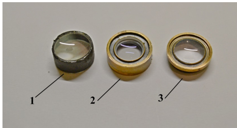
Рис. 6: Лінзи об'єктива (1, 3 – плоско-опуклі, 2 – двовгнута)
