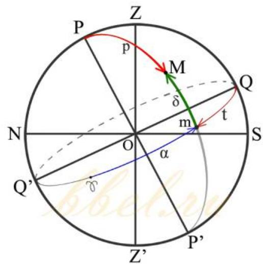
Рис. 2: Экваториальная система координат
