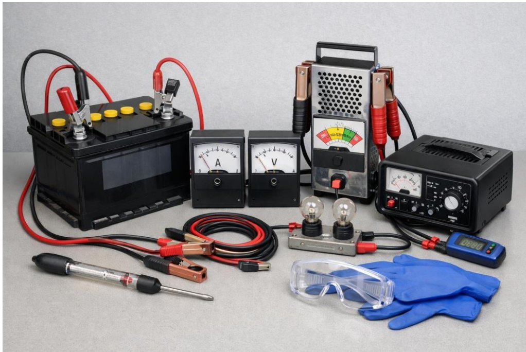
Рис. 1.1. Лабораторна установка дослідження характеристики розряду стартерної акумуляторної батареї.
