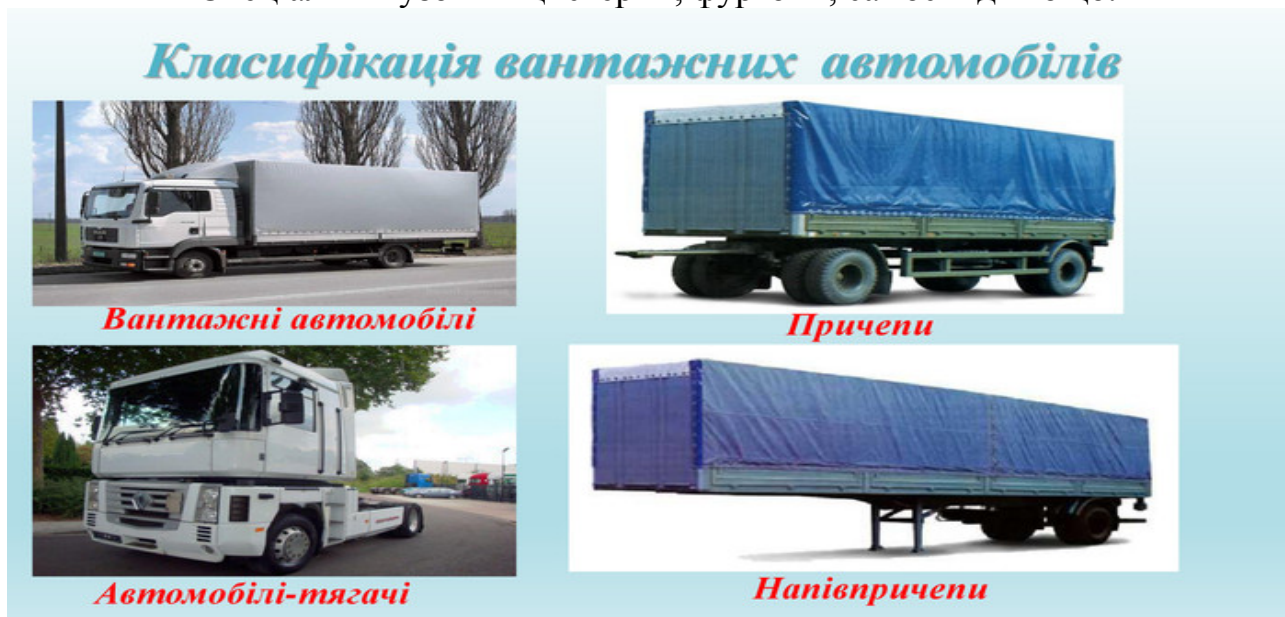
Рис.1.3. Типи кузовів вантажних автомобілів.
