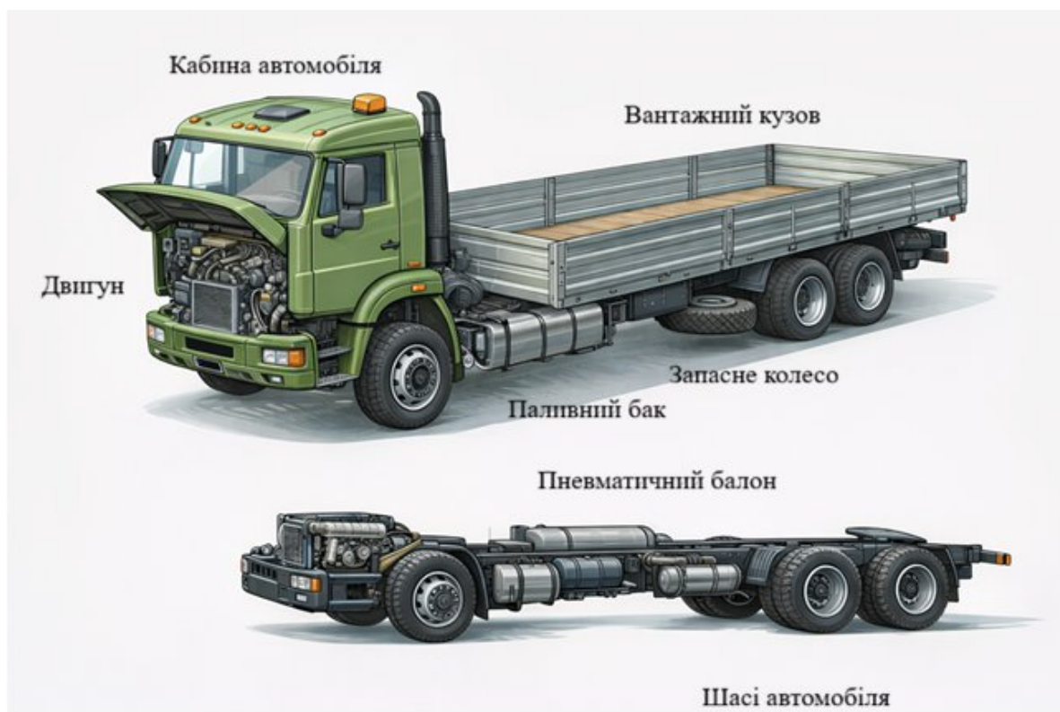
Рис. 1.5. Загальна будова вантажного автомобіля
