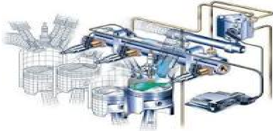
Рис. 3.2. Схема системи живлення в впорскуванні бензинового палива.
