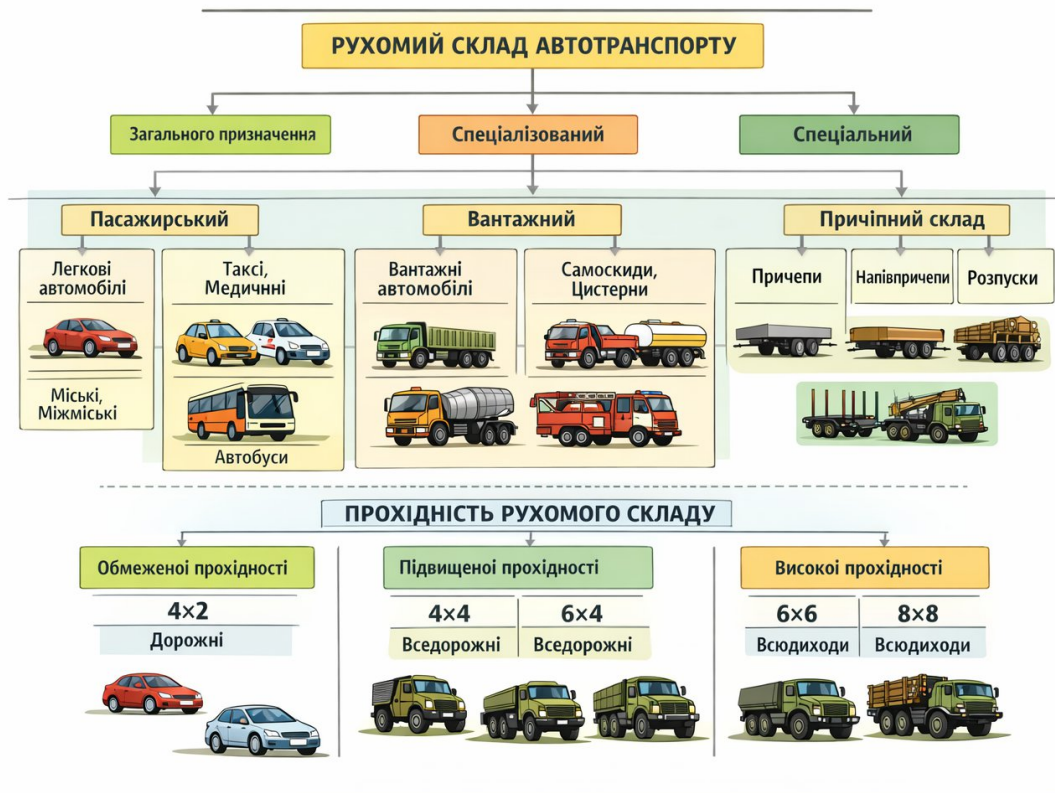
Рисунок 1.1 - Класифікація типів рухомого складу автомобільного транспорту за призначенням і прохідністю
